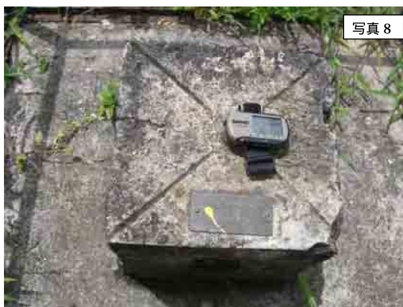
ハンディ GPS による国家水準点 P/014 の測位
