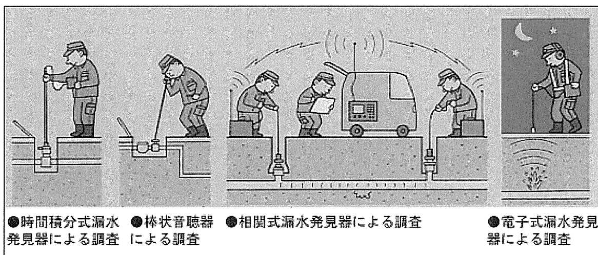
図4-13 漏水位置確認方法の概念図
