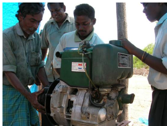
コミュニティの担当者を対象とした深井戸に設置されたディーゼル・エンジンとポンプの維持管理の訓練 (パーリアル村)
