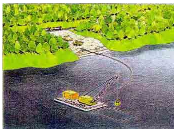
図 7.8.2 浚渫による貯水量確保のイメージ 53
