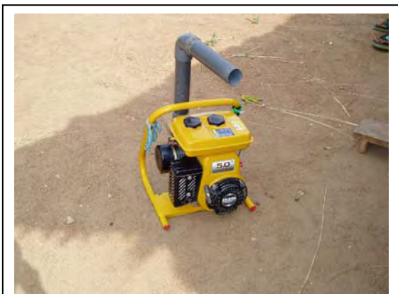
貸出用の可搬式揚水ポンプ
