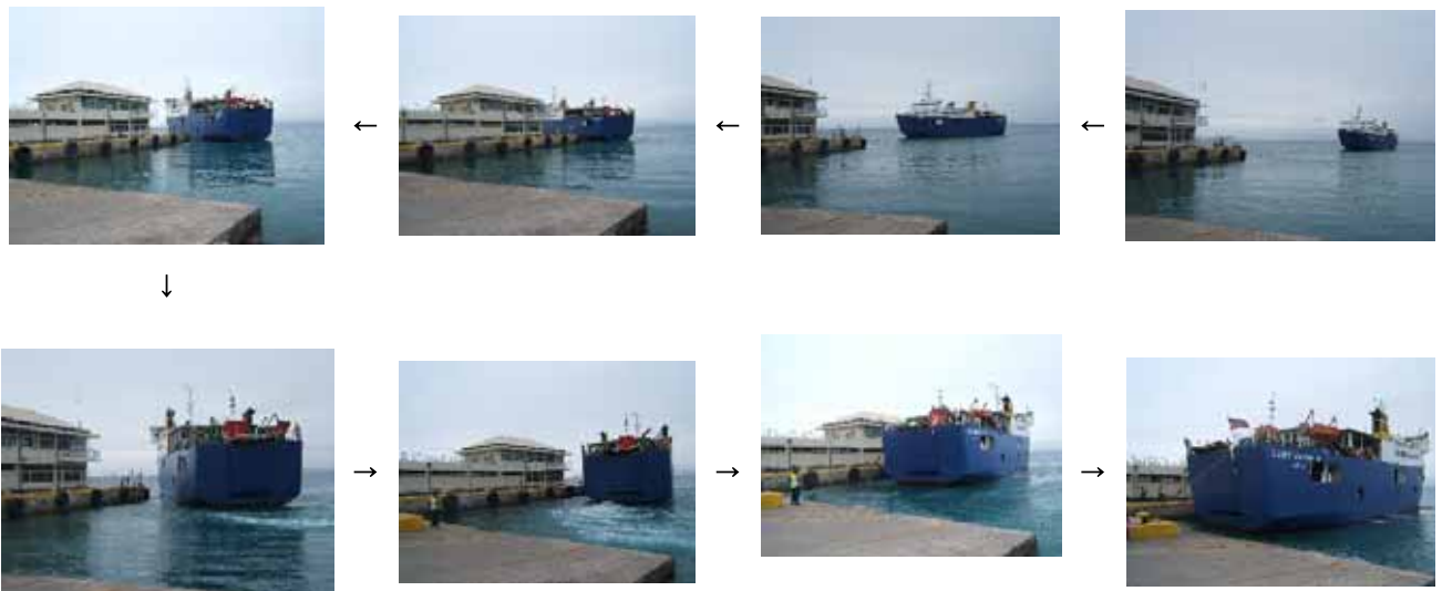
サレロゴガ港での LS2 号の旋回状況 両港とも岸壁の直近に直径約 120 m の回頭域が設けられている。回頭域に余裕がないため、その場旋回を容易に行うために LS2 号は 2 機 2 軸とし、さらにバウスラスターが採用されている。
