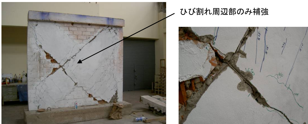
写真 3-14 枠組組積造壁の補強実験例
