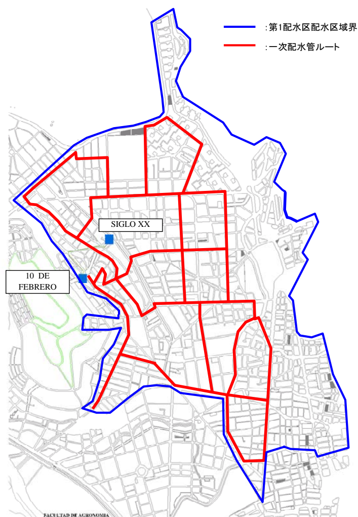
図 3.3 第1配水区一次配水管
