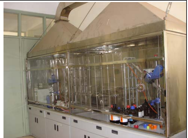
写真4 ロータリーエバポレーター (左右) 有機溶媒を留去するのに用いる (排気ダクトは2006年5月に完成)。
