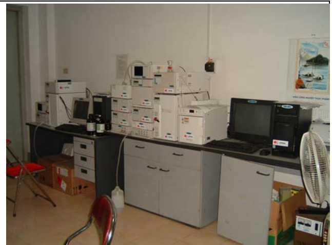
写真2 高速液体クロマトグラフ (HPLC) 短時間で高性能な分離分析を行うことができる。
