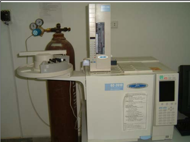
写真1 ガスクロマトグラフ (GC) 気体試料のみならず、気化し得る試料の分析に用いる。
