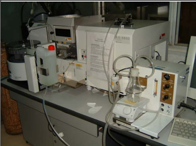
写真3 原子吸光光度計 無機元素分析に用いる。
