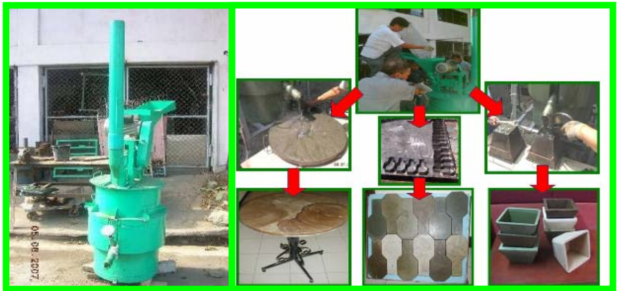
図 3.1.3 廃プラスチックの溶融炉と鋳込みプロセス
