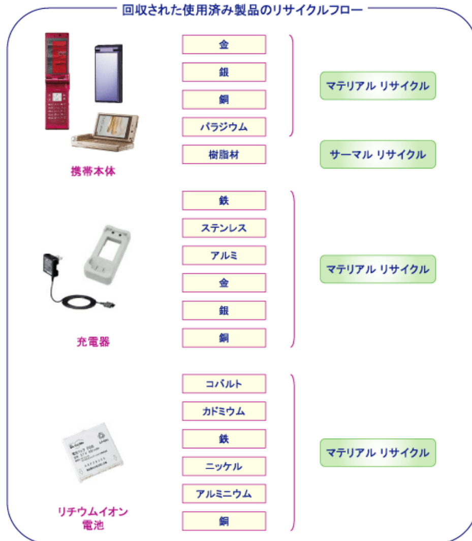
図 3.2.14 携帯電話を構成する素材とリサイクル方法
