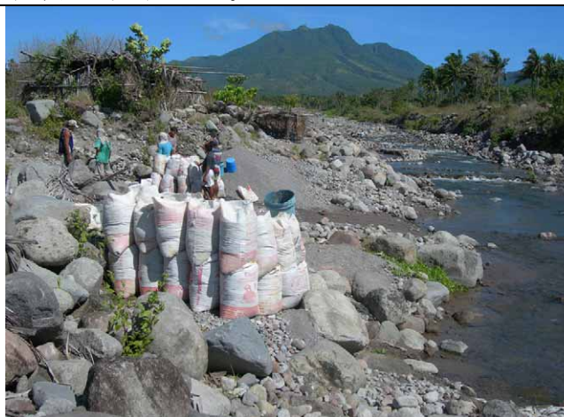
Dinangasan 川における採石現場。 砂、捨石などを袋詰にして建設現場に運搬している。
