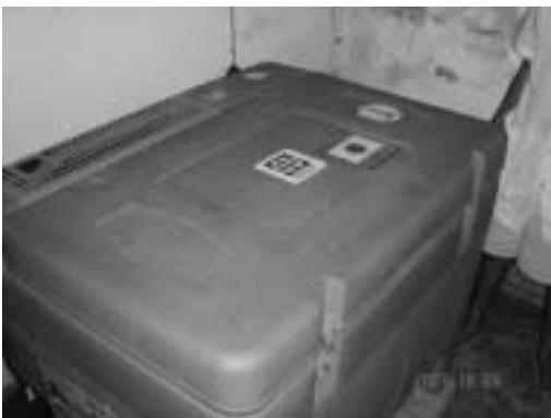
冷蔵庫、小型 (ラメナ基礎保健センター) 2004 年、わが国無償資金より調達、灯油による稼動、状態は良好。
