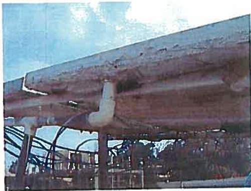
写真-3 同 パネル裏面水冷却実験
