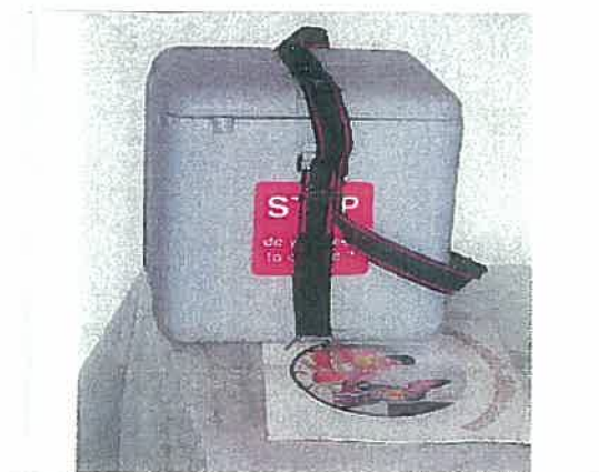
写真5 : 保健センターや保健ポストにあるワクチン保管用コールドボックス。保健センターや保健ポストには冷蔵設備がないため、予防接種日にこれを用いてワクチンを一時的に保管する。
