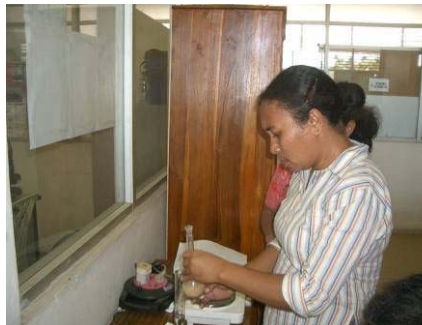
比重試験 (サンプル重量の計測)
