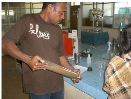
粒度試験 (サンプルと水との混合)
