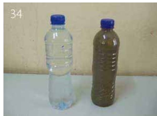
合流点近くで採水したベモス川（左）、コモロ川（右）の表流水サンプル
