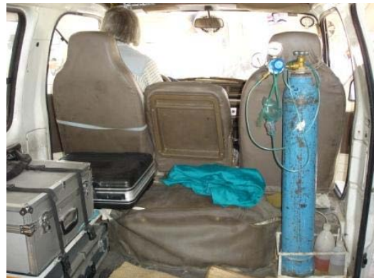
写真-2:酸素ボンベが運転中に倒れないようにするために紐で固定している。
