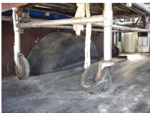
写真-5:バグダッドブリッジ診療所にある救急車のストレッチャーの車輪は老朽化のため破損している。
