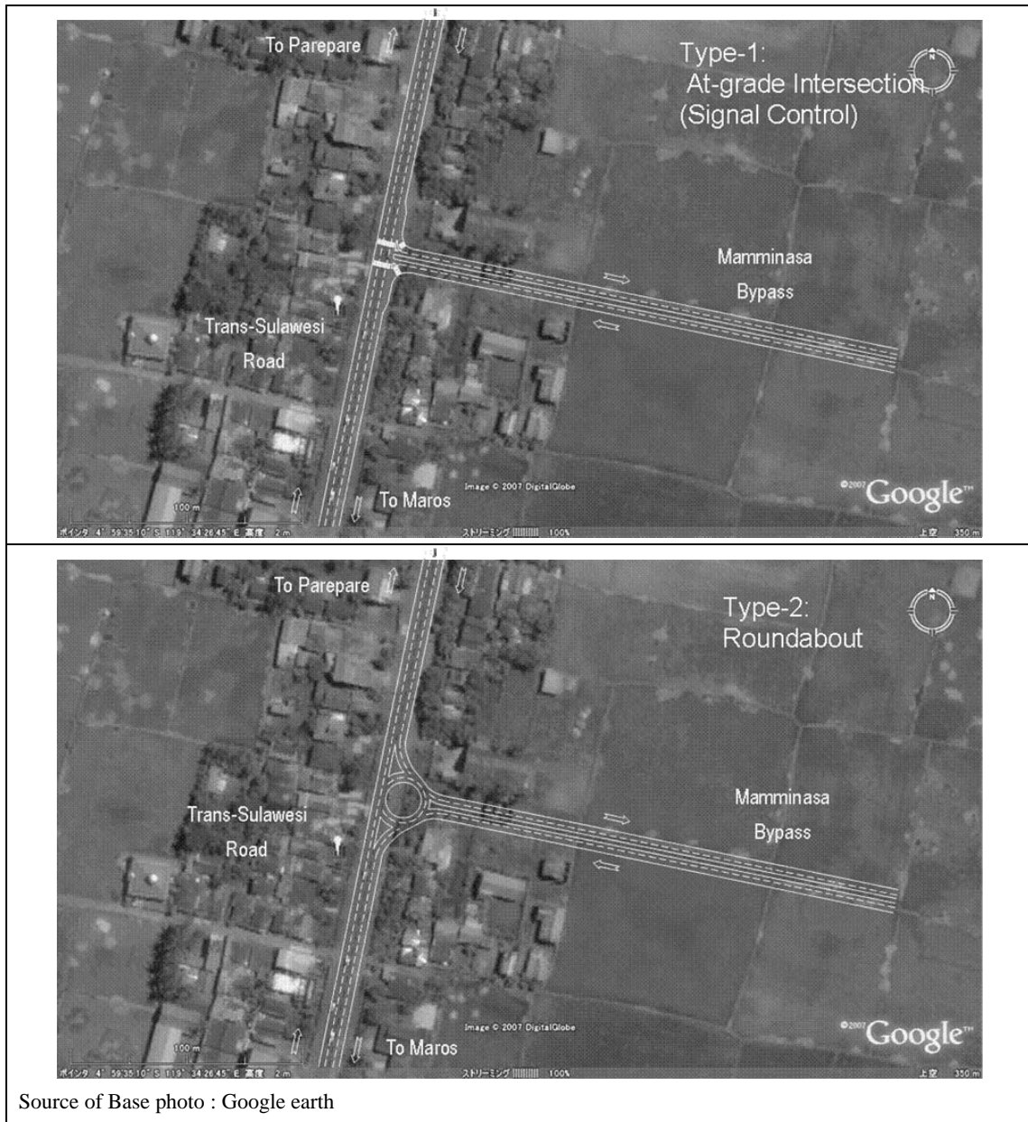
Gambar 7.8.9(2) Rencana Alternatif Persimpangan TS-8 IC
