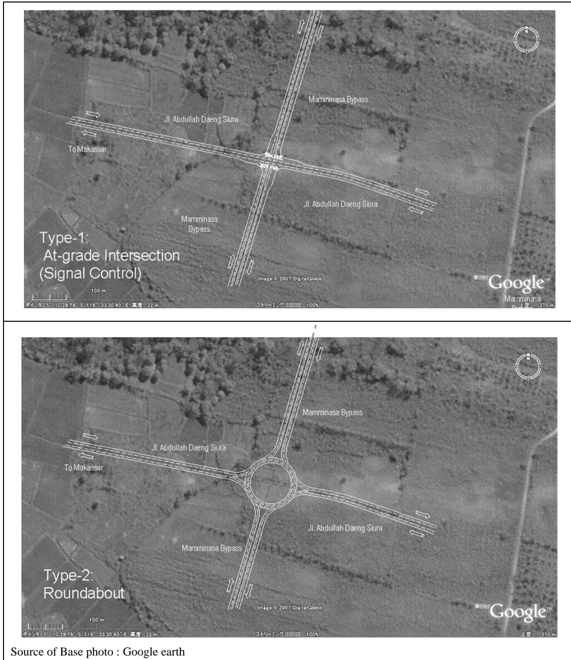
Gambar 7.8.11(2) Rencana Alternatif Persimpangan MB-2 IC
