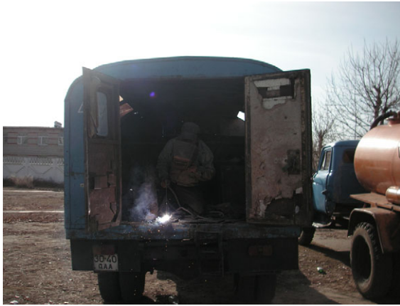
ダルハン市上下水道公社保有の発電機及び溶接機を積載した維持管理用トラック（非常に老朽化している）
