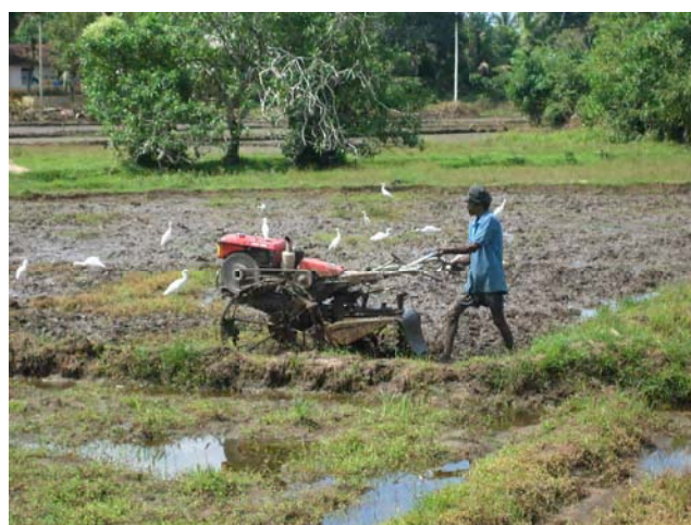
歩行用トラクターによる耕起作業 マータラ (Matara) 県Uragasmanhandiya地域にて
