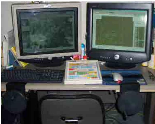
図 3.3.7 ステレオ・デジタル図化機
