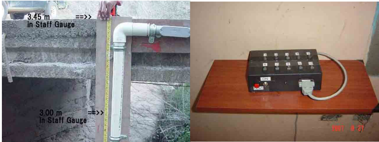
Foto S8-2-16 Comparación de la Escala y caja de Alarma del Sensor Tipo Electrodo
