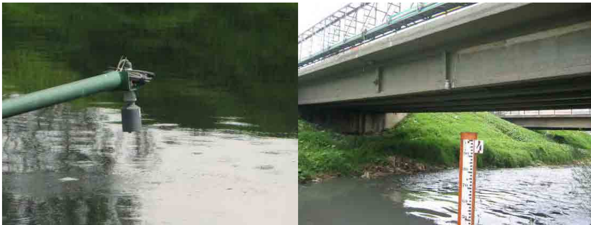
Foto S8-2-1 Sensor de Medición sin Contacto (izquierda: EAAB Estación La Isla, Río Bogotá, derecha: DPAE Estación San Benito, Río Tunjuelo)
