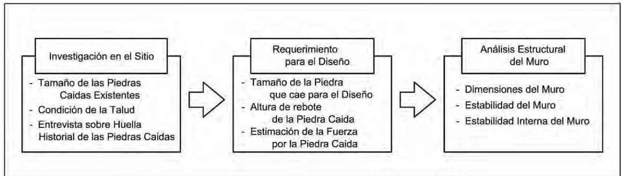
Figura 11-3 Flujo del Diseño de la Muro de Protección
