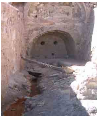
閉坑からの酸性 廃水滲出状況 （セロリコ）
