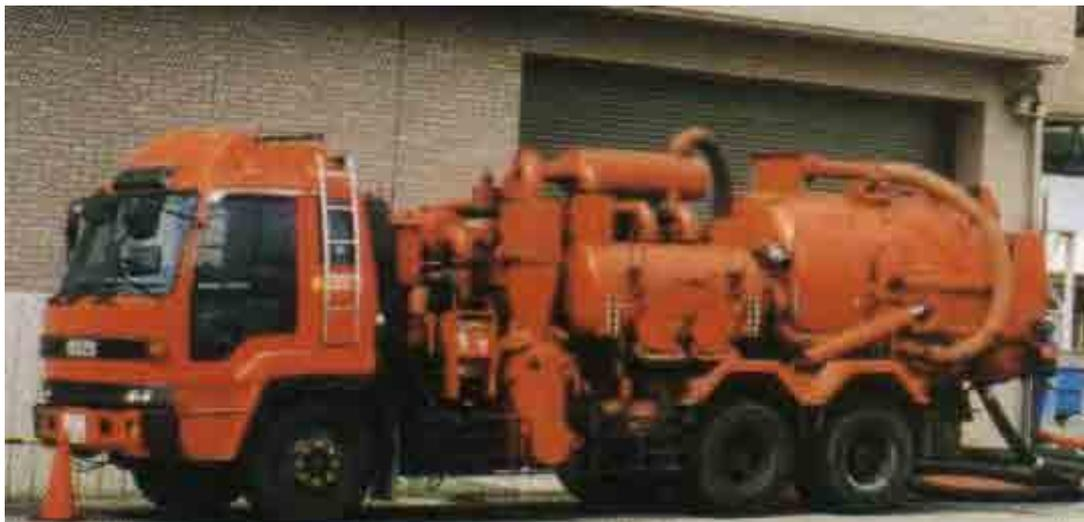
吸引風量  $80\text{m}^3/\text{min}$
