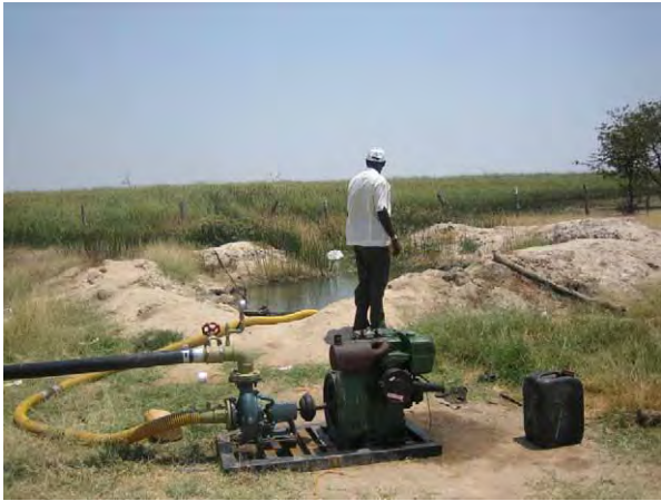
写真9 小規模農家による小型ポンプによる用水路からの取水。(エトウンダ近郊の小規模農場)
