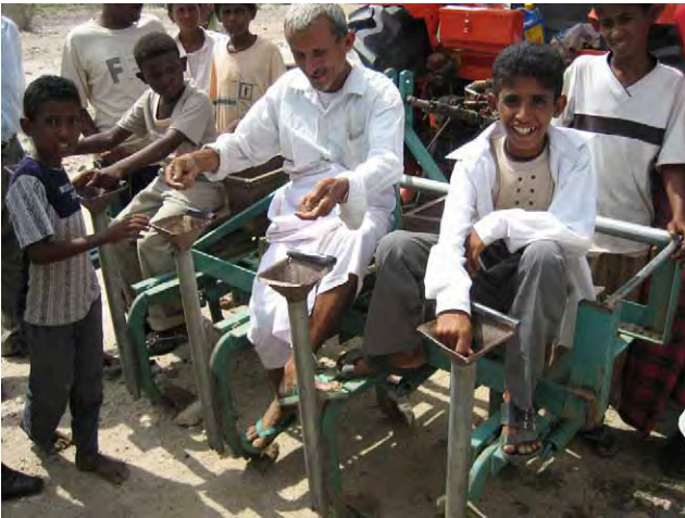
写真-3 <過去2KR供与機材③> イタリア製作業機(タインカルチベーター)(2004年度供与)。農家が改良し、播種作業を可能にしている。ハッジャ州の農家にて(11月3日訪問)。
