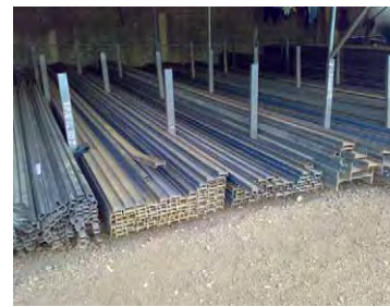
形鋼材 (I形鋼、角鋼)
