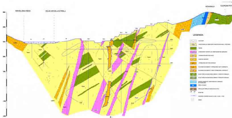
図 4.11 Veliki Krivelj 露天掘の地質断面図
