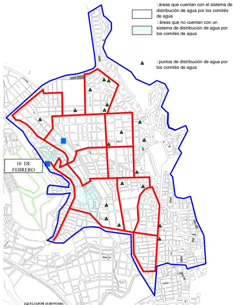
Figura 2.4 Área de abastecimiento por las tuberías secundarias y de los equipos de suministro
