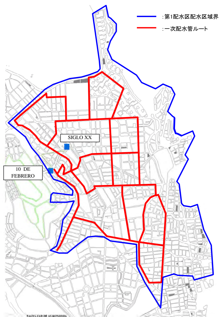
図 3.3 第1配水区一次配水管
