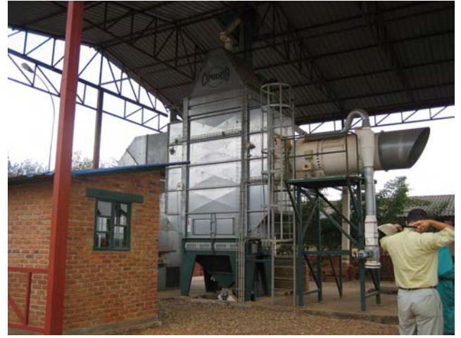
写真2： RADAの敷地内にある大型コメ乾燥機。自然乾燥による水分除去が十分でない場合に使用する。ディーゼルエンジンで稼動し、60ℓ/時の処理能力がある。デンマーク製。
