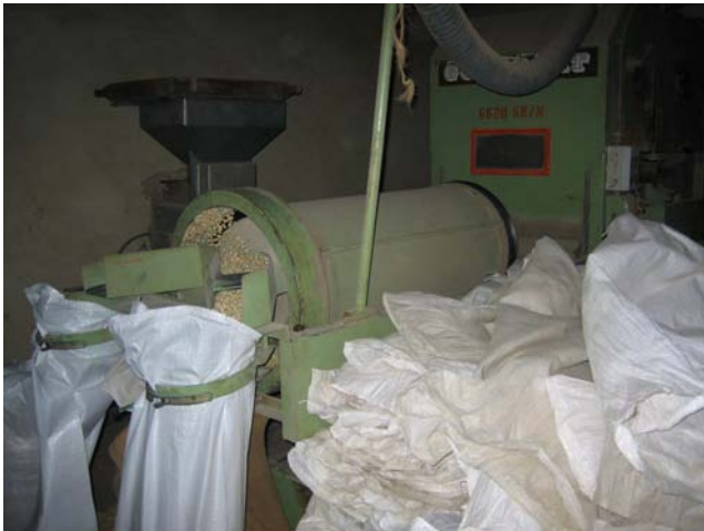
写真3： RADAの倉庫内にあるトウモロコシ用乾燥分粒機。中国製。種子の大小を選別し、袋詰めまで行なえる。
