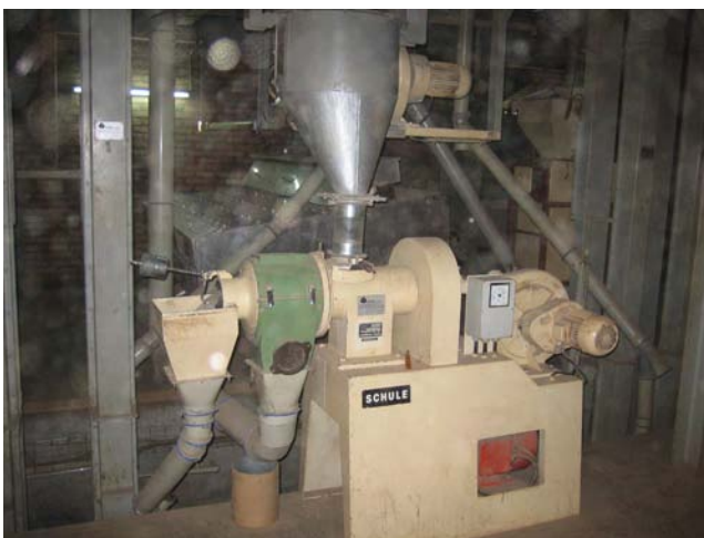
写真5： 南部県ギサガラ郡のギコンコ精米工場。フランスの援助で建設された施設を内戦後ベルギーの援助で修復した。年間7,000トンの処理能力がある。
