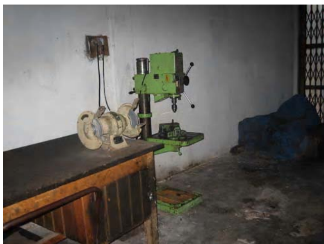
<写真11> バジョの地域農業機械化センター(RAMC)にある工作機械。AMC本部よりも簡易な工作機械しか配置されていない。
