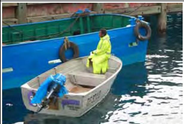
写真-6：パイロットボートの代替船（平底船のため洋上で不安定である）
