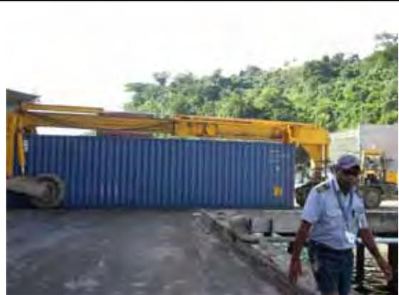
写真-5：狭小な埠頭棧橋でのコンテナムーバー（SISU）による作業状況
