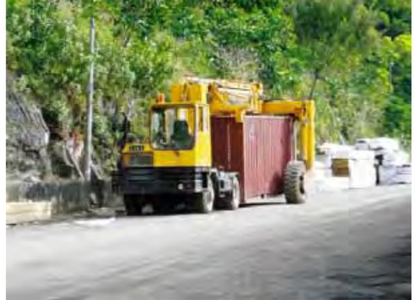
写真-9：コンテナムーバーによる場外搬出状況（公道を走行するため危険である）
