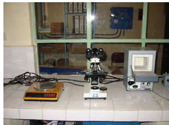
既存ミルネル浄水場のラボにある水質試験用機器（電子天秤/顕微鏡/蒸発釜）
