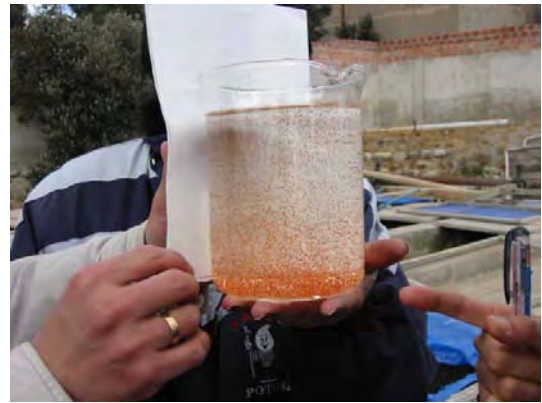
既存ミルネル浄水場に流入したプランクトン藻類
