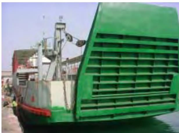
船首ランプドアの状態 再塗装、部分補強済み。
