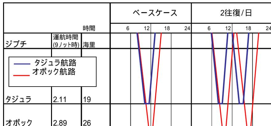
図3-5 新フェリーの運航スケジュール想定 (横軸に時間、縦軸に航続距離を示す)
