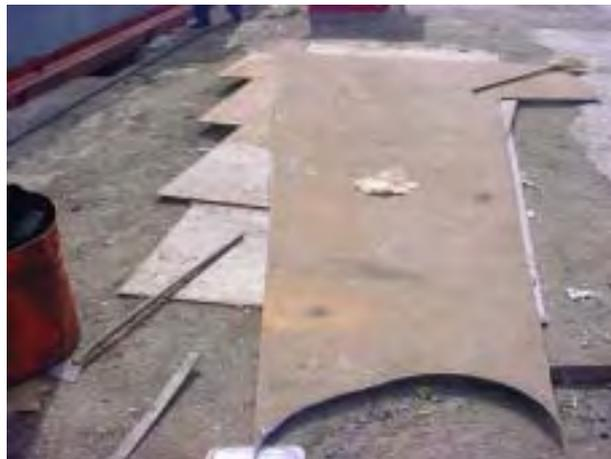
船体補強のために準備された鋼板
