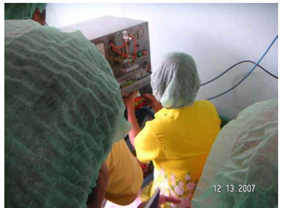
機械でガス注入 (機械は注文生産)
