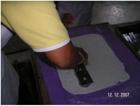
型で抜く工程
