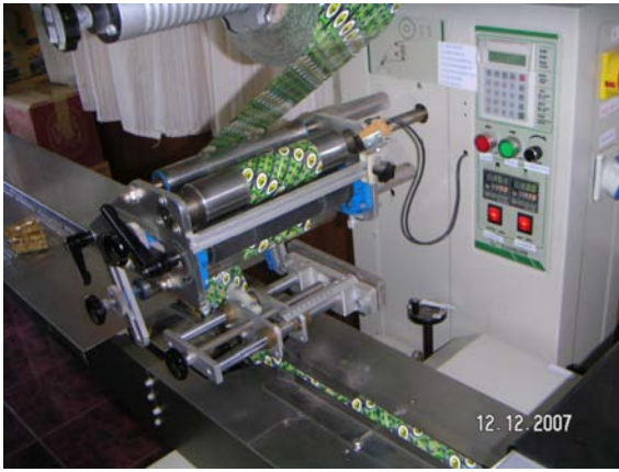
オートメーション化された袋詰め作業
