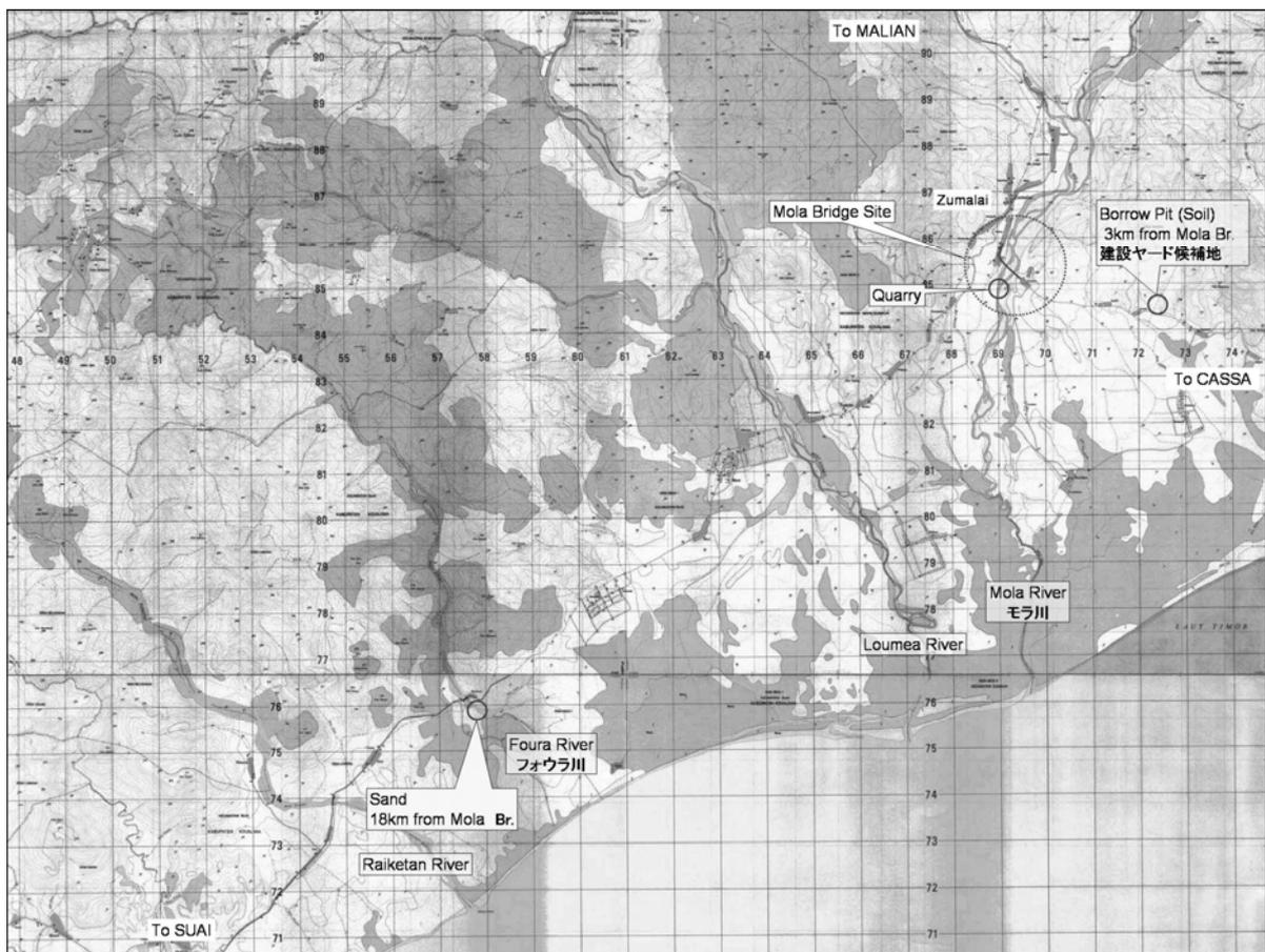
図 2-4 建設サイト近傍の採石・砂場、土取場の位置図
