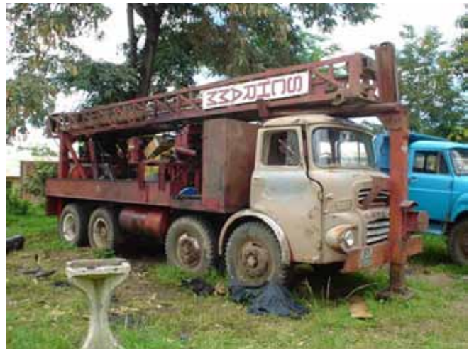
MoWLD 傘下 DDCA Mwanza 支所保有の井戸掘削リグ (アメリカ SCHRAMM 社製 30 年程度使用)
