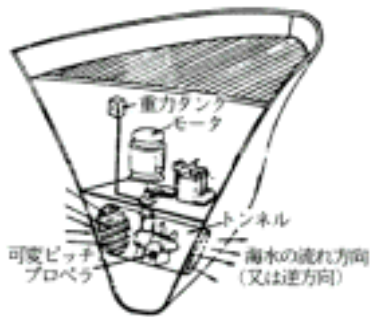
図 3-14 バウスラスター
