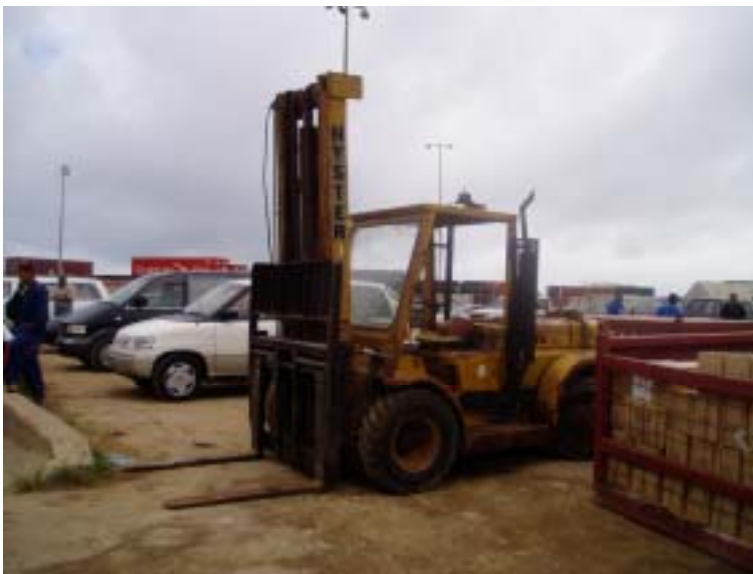
既存フォークリフト (Hyster社製6.5t) 荷役用としてオロバ八号に搭載 老朽化が激しい
