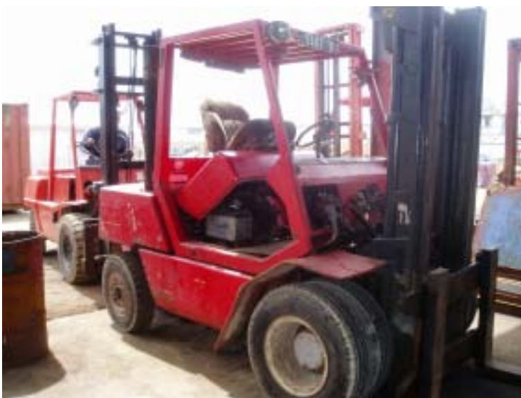
既存フォークリフト(トヨタ3.8t) 荷役兼工場用 故障頻発
