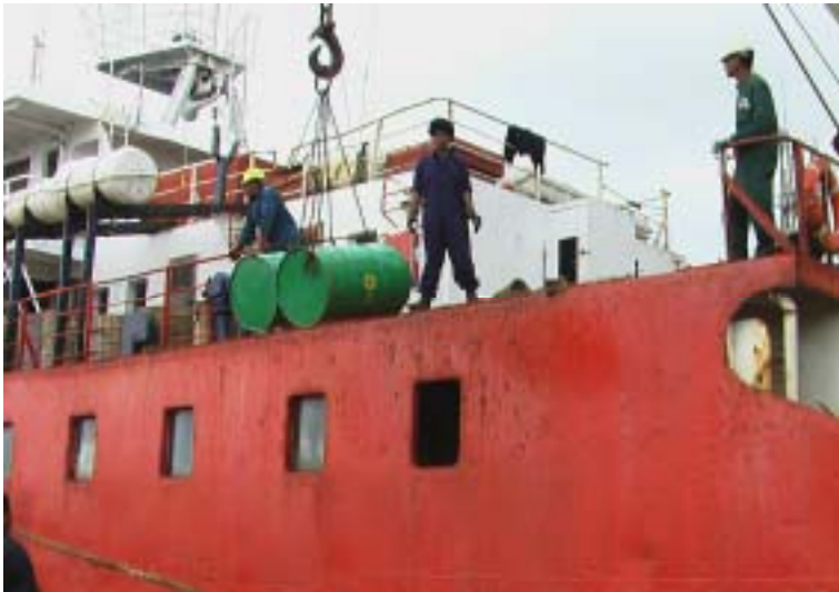
ドラム缶の荷役作業 船上での運搬は人力、船外に下ろす時にはデリックブームを用いる
