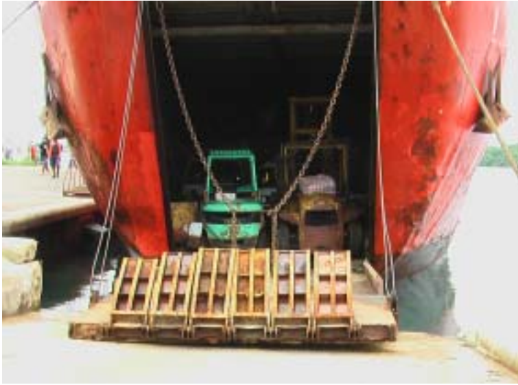
オロバ八号の貨物倉 荷役用のフォークリフトを搭載し ている
