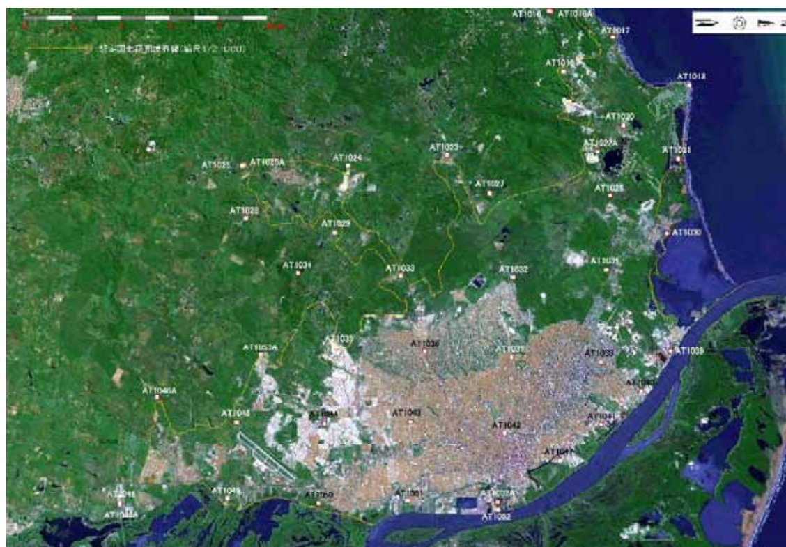
Figura 5-3-2 Ubicación de puntos de fotocontrol (Puntos pinchados) Área Metropolitana de Barranquilla
