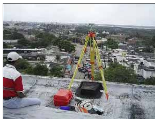
Levantamiento de GCP #2 (Confirmación de los puntos observados en las aerofotos y pinchados.)
