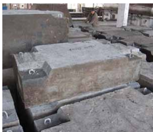
Завершение бетонного кубика: 2.0м x 1.0м x 0.5м
