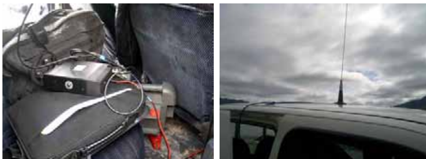
Рис. R 8.4.8 Мобильные рации (слева) и антенна, установленная на магнитной базе (справа)
