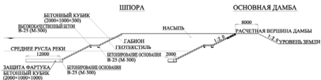
Рис. R.4.2.18 Типовое сечение дамбы со шпорой
