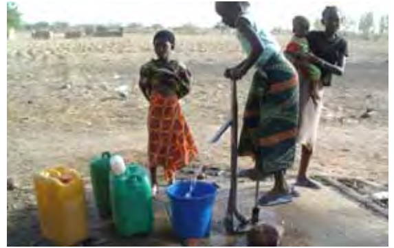
既設人力ポンプ（ペロニエ型足踏みポンプ）
