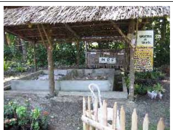
よい事例2：BMRF（Biodegradable Wasteはコンポスト化、Recyclable Wasteは有価物として回収）
