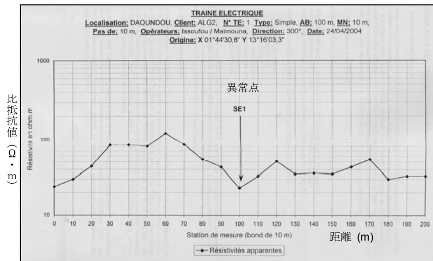
図 2.3.9 ティラベリ州の基盤岩地域の典型的な水平電気探査曲線 出典：ティラベリ州農村給水プログラム ALG 2 - Niger 報告書
