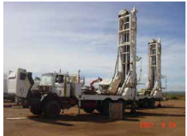
フランスに本社がある井戸掘削会社の FORACO 社のワークショップで定期点検を受けている同社所有の 2 台の FORACO 製の 1000m 級井戸掘削機、大深度掘削機械は堆積層での井戸掘削に使用、ロータリーと DTH の両方に対応、点検・修理体制は非常に良く整っている
