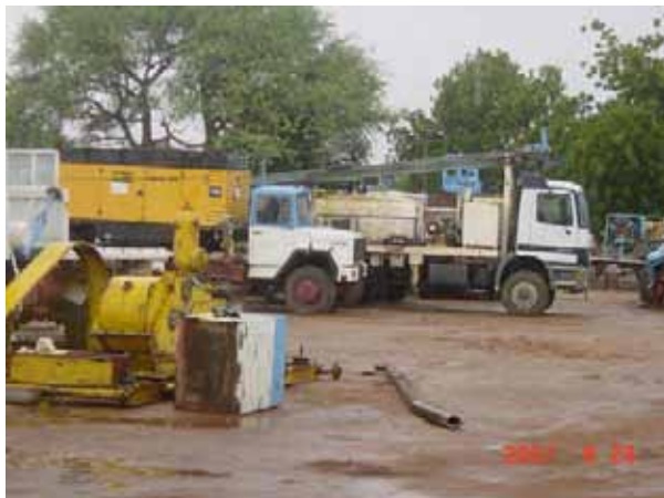
BELKO 社保有のフランス製 300 級井戸掘削機械とアトラスコプコ社のエアコンプレッサー、主に岩盤地域の井戸掘削に使用、ロータリーと DTH 両方に対応、点検・修理体制は比較的良く整っている
