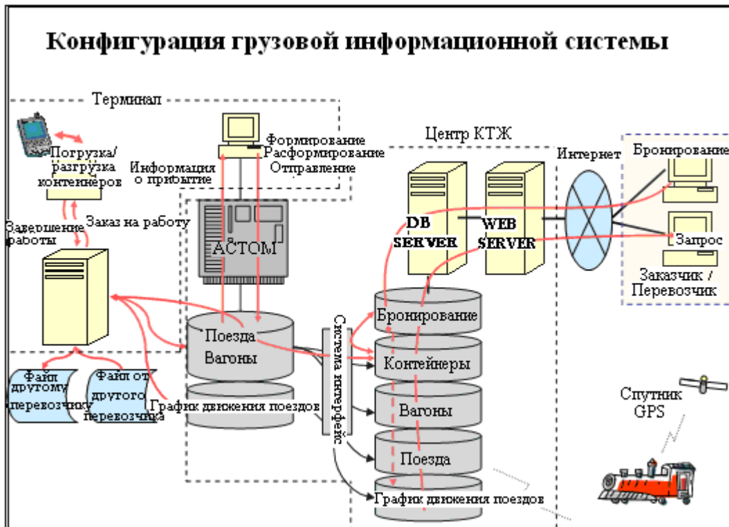
Рисунок 7.5-6 Конфигурация грузовой информационной системы
