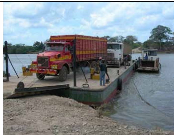
オレンジ運搬に使用されるトレーラを乗せて渡河するポンツーン（右側に見えるのが動力船）
